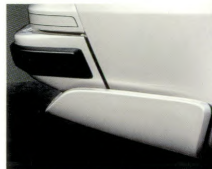
Le Cx de la 944 S2 et de la 944 Turbo a été affiné en soufflerie
