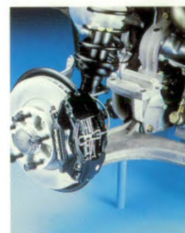
Suspension avant avec bras transversaux en alliage léger
