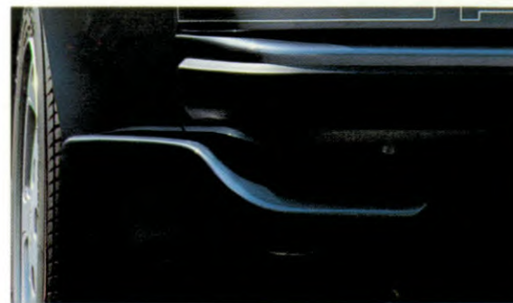
Le pare-chocs-bouclier en résine synthétique absorbe sans problème les petits chocs jusqu'à 5 km/h
