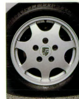
Des roues en alliage léger pour réduire les masses non suspendues
