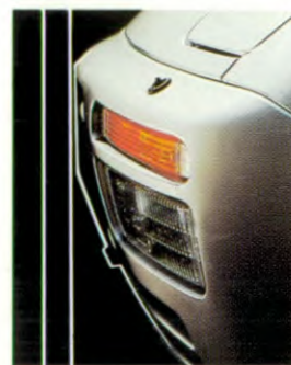
Le bouclier avant en résine synthétique supporte les petits chocs
