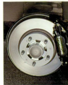
Les freins à disques ventilés avec étriers fixes à quatre pistons à l'avant
