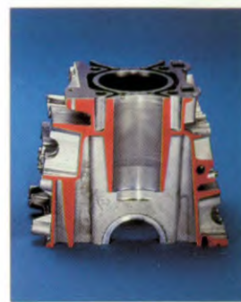
Son alésage important prédestinait ce moteur aux 16 soupapes
