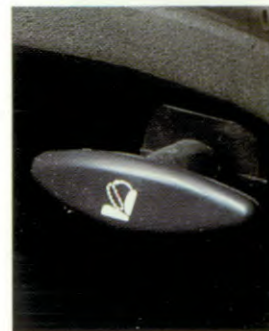
Les dossiers des sièges arrière se rabattent séparément à l'aide d'un levier
