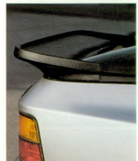
Meilleure aérodynamique et plus faible portance grâce au becquet arrière
