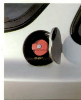
L'accès du bouchon de réservoir est protégé par un volet
