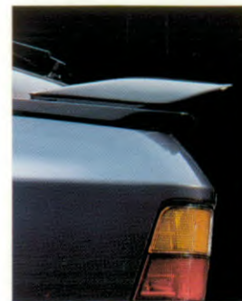
Le becquet arrière réduit la portance et favorise la pénétration dans l'air
