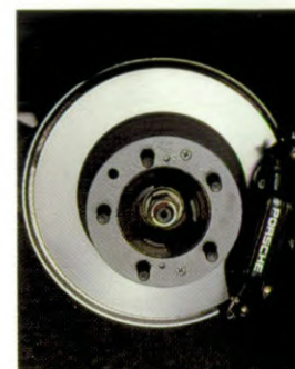
Les freins arrière possèdent eux aussi des disques ventilés
